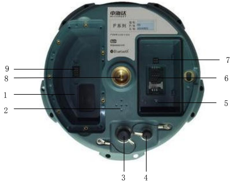
1-通信模块仓 2-喇叭 3-八芯插座及防护塞 4-五芯插座及防护塞 5-电池仓
